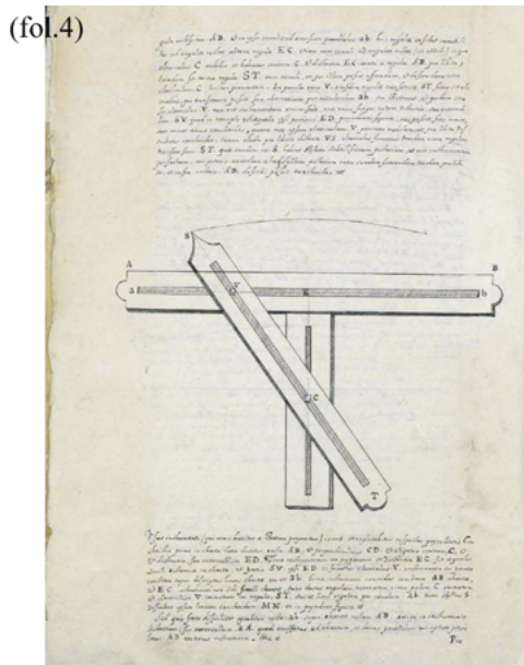
Figura 1: Instrumento de Nicomedes (280-210 Ac) para el trazado de un conoide, a) Apiaria universae philosophiae mathematicae (1642), Mario Bettini; b) Observationes diversarum artium (1669), Fray Ignacio Muñoz [BNE Mss/7111].
