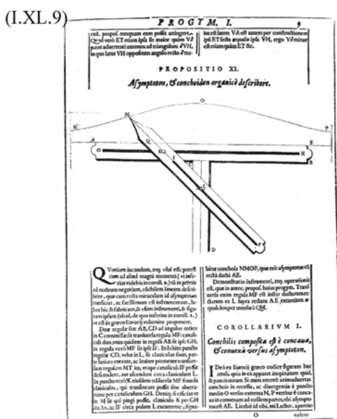
Figura 1: Instrumento de Nicomedes (280-210 Ac) para el trazado de un conoide, a) Apiaria universae philosophiae mathematicae (1642), Mario Bettini; b) Observationes diversarum artium (1669), Fray Ignacio Muñoz [BNE Mss/7111].
